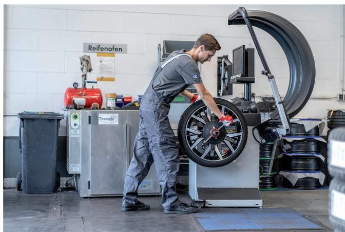
Im Reifenofen wird der Reifen weicher und kann ohne Schäden auf neue Felgen aufgezogen werden. Foto: Autohaus Diether
